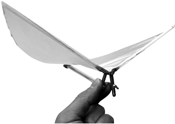
図11 はばたき飛行機。 材料：3Dプリンタで作った部品（5点）、ストロー、輪ゴム、クランク用のピアノ線、ビーズ、樹脂ワッシャー（スパンコール）、ポリ袋。
