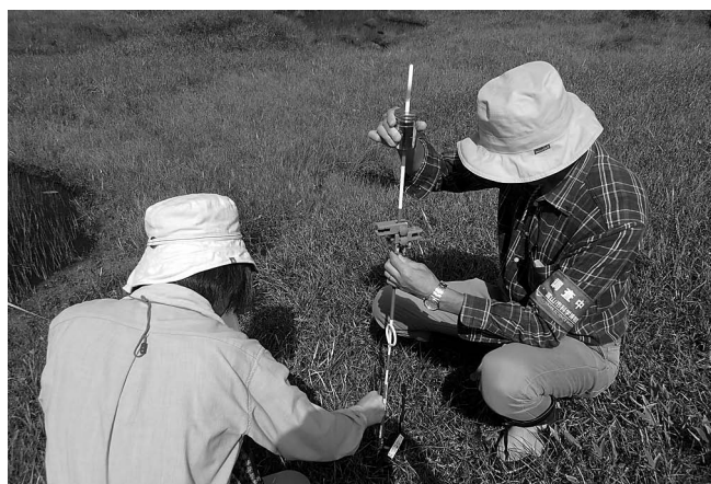
図2 池塘③のピンポール調査（2019年10月1日） 調査員の右手に持っているものがメッセンジャー、左手の上がストッパー。
