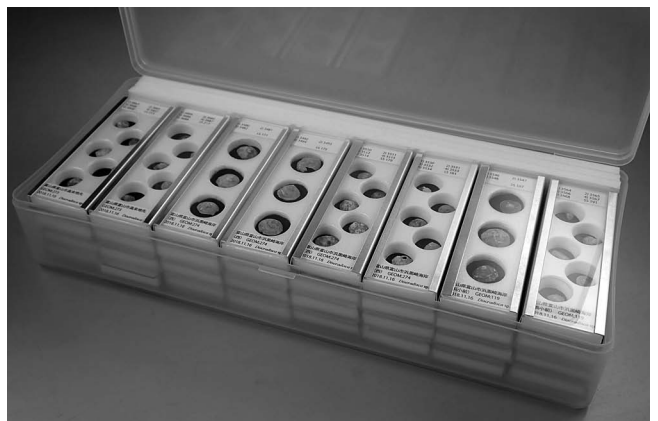
図4 収納例 (スライドは一時保管用)。市販の蓋つきポリエチレンケースに重ねて収納し、後部の余白はスライド作成時に端材となったポリスチレンボードで埋めた。
