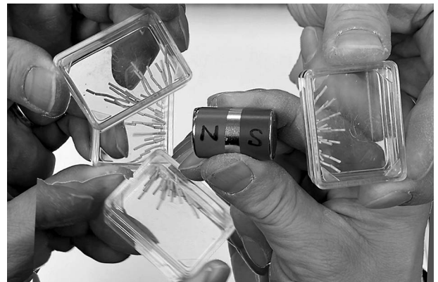
図2 磁石の周りの磁力線に見える化する（合成写真）。
