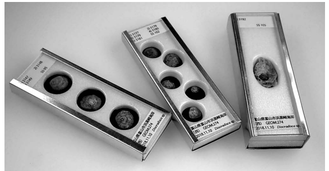
図1 作成した微小貝スライド(一時保管用)。左は3穴、中央は5穴でいずれもホール部の厚さ5 mm。右は1穴で厚さ10 mm。
